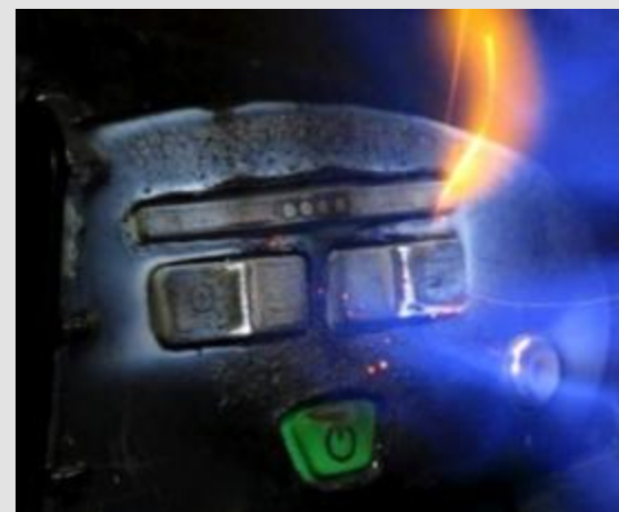
Klávesnice po testu odolnosti vůči plamenům
