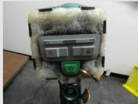
Klávesnice po testu odolnosti vůči horku
