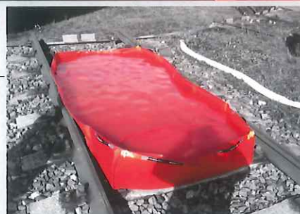
Vanu je možné umístit pod vlak nebo jiné drážní vozidlo dvěma způsoby: napříč přes koleje nebo podélně do vnitřního prostoru mezi kolejemi. Oba způsoby použití byly podrobeny náročným testům.
