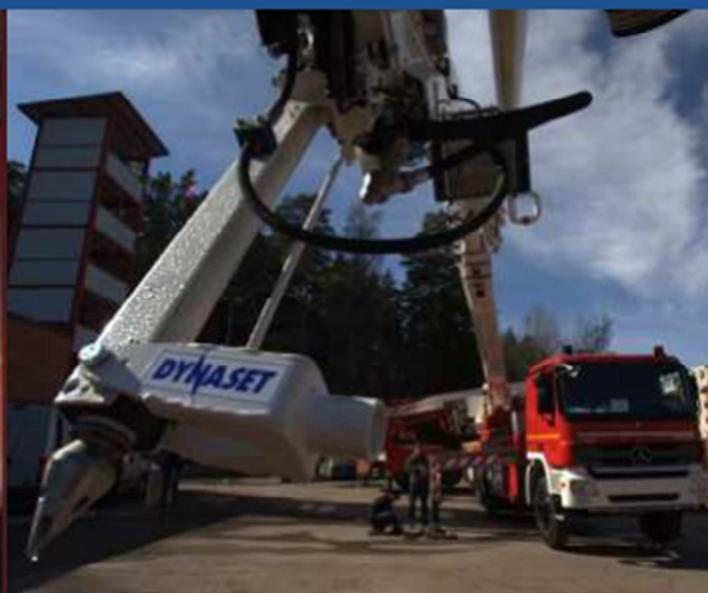
V případě existence většího počtu ohnisek ohně lze jednoduše a během několika sekund přesunout průraznou sadu na jiné místo a opět proniknout skrz plášť budovy k dalšímu ohnisku. Díky použitým moderním bezpečnostním technologickým prvkům již není potřeba, aby hasiči vstupovali do budovy, vylamovali dveře, okna či střešní krytinu.
