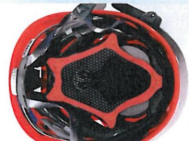
← **Detaillreich** Petzl hat beim Altios einige nützliche Details eingebaut: Das Nackenband mit dem Drehrad ist höhenverstellbar, das Kinnband nur einfach durch die Schnalle geschlauft. Das Meshpolster kann ebenso wie das Polster am Stirnband zur Reinigung entfernt werden. Bei tiefen Temperaturen können die Lüftungsschlitze mit Schaumstoffpads von innen abgedeckt werden.
